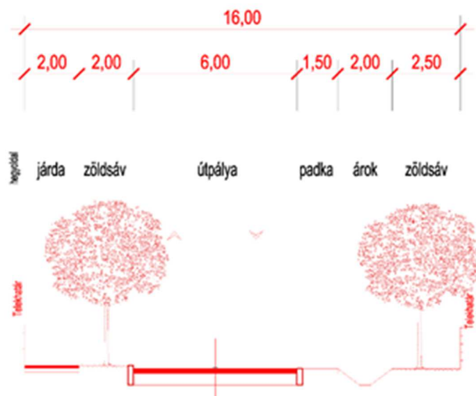
28. A "D" jelű út (tervezett gyűjtőút) mintakeresztmetszelve
